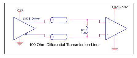
FIGURE 4. TYPICAL LVDS DRIVER TERMINATION
