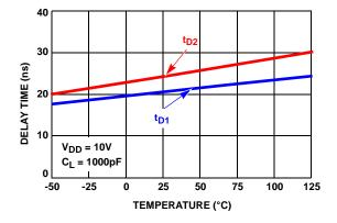
FIGURE 13. DELAY vs TEMPERATURE
