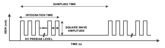
FIGURE 9. EMITTER DRIVER WAVE FORM
