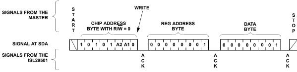
FIGURE 13. EXAMPLE BYTE WRITE SEQUENCE
