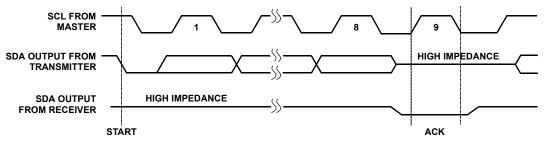
FIGURE 12. ACKNOWLEDGE RESPONSE FROM RECEIVER
