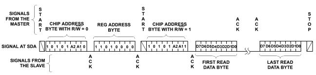
FIGURE 14. MULTIBYTE READ SEQUENCE
