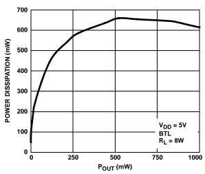
FIGURE 23. POWER DISSIPATION vs OUTPUT POWER
