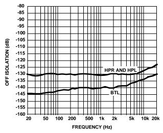
FIGURE 20. OFF ISOLATION vs FREQUENCY
