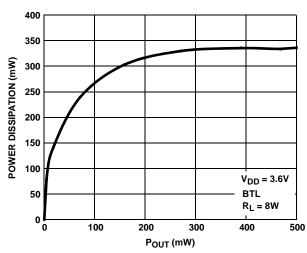
FIGURE 24. POWER DISSIPATION vs OUTPUT POWER
