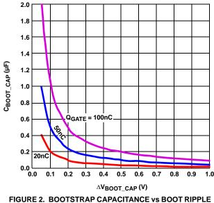
GURE 2. BOOTSTRAP CAPACITANCE vs BOOT RIPP VOLTAGE
