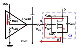
FIGURE 4. TYPICAL LOWER-GATE DRIVE TURN-ON PATH
