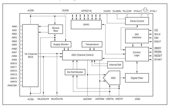
Figure 33. ADS1258 Block Diagram
