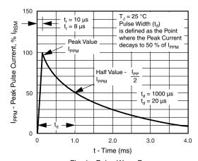
Fig. 1 - Pulse Wave Form
